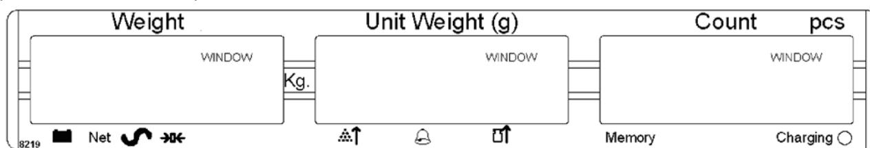
La bilancia mostrera' il numero del modello sul display "**Weight**" (ad es.: CBC 30- dove 30 indica la capacità massima della bilancia in Kg) e i numeri di revisione dell'hardware e software sul display "**Unit Weight**". Quindi seguira' una prova automatica. Alla fine della prova, viene visualizzato il messaggio "**0**" in tutti i 3 display, se la condizione di zero è stato raggiunta.
