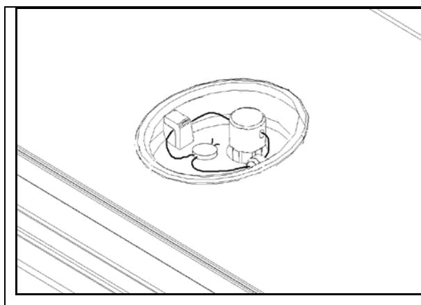
Zur Versiegelung der Waage kann eine Metallplombe benutzt werden, wie links gezeigt. Im Unterteil der Waage ist ein Stift aus Metall, der aus der Schutzabdeckung hervorragt. Die Plombe kann durch diesen Stift eingefädelt werden. Das Entfernen der Abdeckung ohne die Plombe oder das Gehäuse zu verletzen ist dann unmöglich
