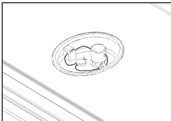
Pour sceller la balance un câble plombé peut être utilisé comme montré ci-contre. La base possède une goupille en métal qui sort à travers du boîtier. Le plomb de sécurité peut être fixé à travers sa goupille en métal, rendant impossible l'extraction du couvercle sans endommager le plomb de sécurité ou le boîtier.
