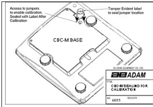
Le calibrage de la balance CBC-M est accompli en retirant l'étiquette de la base de la balance laquelle couvre un trou à travers lequel le circuit interne PCB peut être atteint. Si votre balance n'est pas fournie avec cet accès, vous devez alors casser le plomb de sécurité et enlever la partie haute du carter pour accéder au circuit interne. Voir l'illustration sur le plomb de sécurité ci-dessous.
