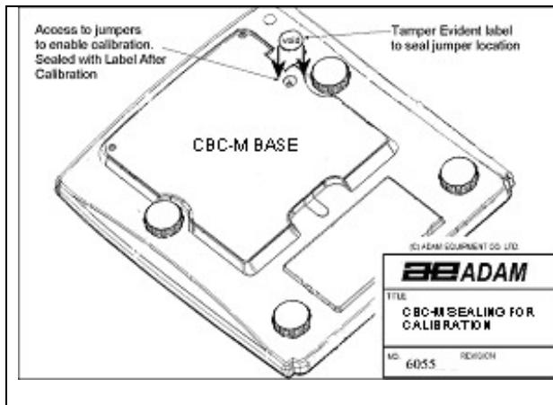
La calibración de la báscula AZextra es realizada retirando la etiqueta de la base de la báscula que cubre el orificio a través del cual la PCB puede ser accedida. Si su báscula no es suministrada con este orificio, usted necesita romper las cerraduras de seguridad y retirar la cubierta superior para conservar el acceso a las tablas de circuitos interiores. Vea la figura con la cerradura de seguridad debajo.
