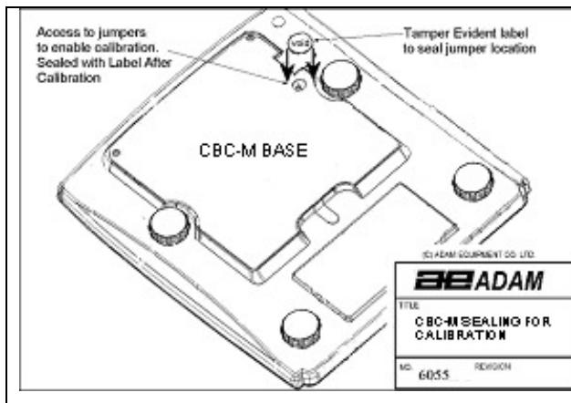
Um die Kalibrierung der CBC-M-Waagen durchzuführen, entfernen Sie die Marke auf dem Unterteil der Waage über der Öffnung, durch die Sie Zugang zur Leiterplatte haben. Ist diese Öffnung nicht vorhanden, müssen Sie die Siegelmarke bzw. Plombierung aufbrechen und den Schutzdeckel entfernen, um an die interne Leiterplatte zu gelangen. Siehe untere Skizze (Sicherungssiegel)
